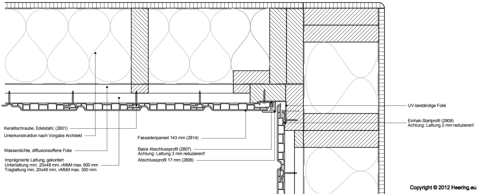
**Betrifft:** Vertikale Montage Fassadenpaneel 143 mm
